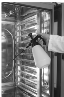
Aspersion de l'enceinte de cuisson
