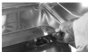
Nettoyage du bac de déshumidification
